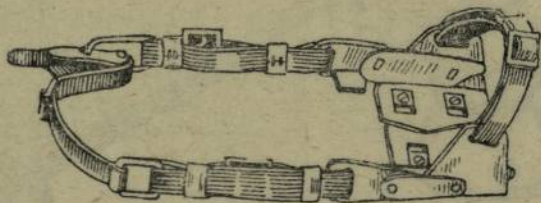
Рис. 78. Армейское лыжное крепление с металлическими скобами, обр. 1940 г. (с левой лыжи).
