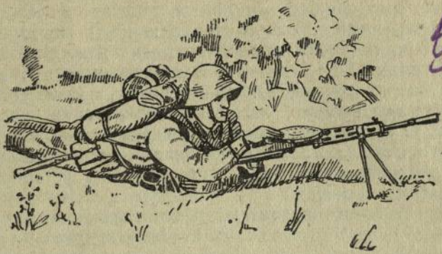
Рис. 17. Заряжание пулемета (присоединение магазина).
