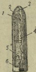
Рис. 1б. Германская разрывная (пристрелочная) пуля.
